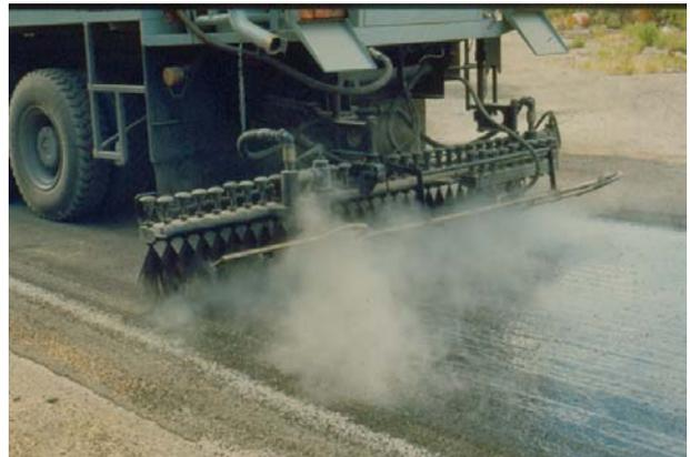
Foto 5. Estrías en el riego por altura incorrecta de la rampa
