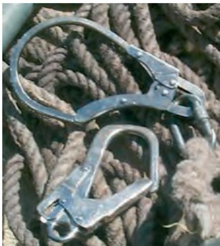
Figura 3.4.9. Ganchos que bloquean la posible salida de los elementos a izar
