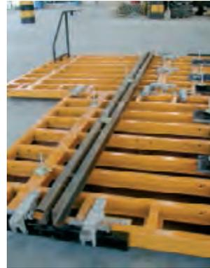
**Figura 3.5.3.47. Vela posicionada en encofrado modular**
