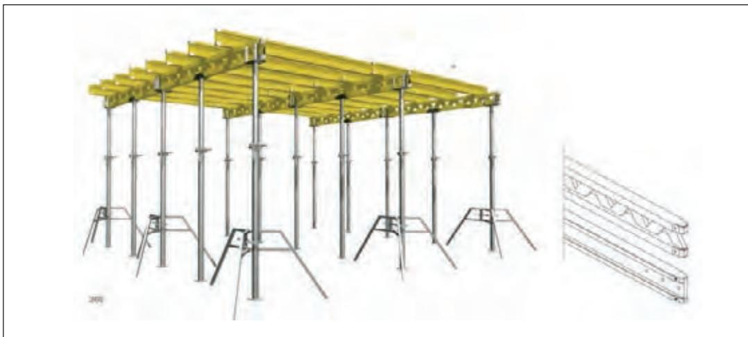
**Figura 3.5.2.1. Encofrado flexible de vigas de madera**
