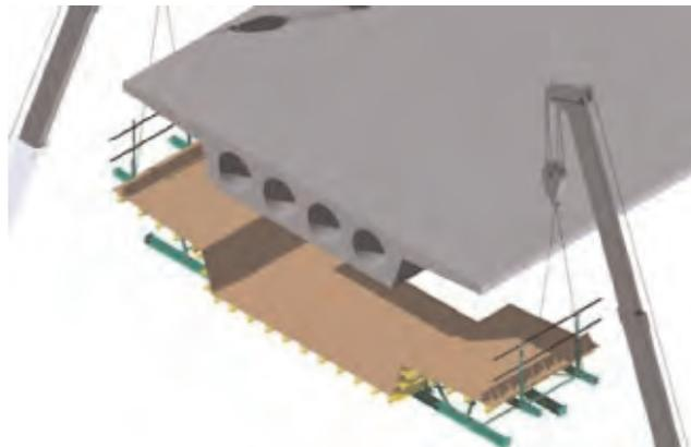
**Figura 3.5.3.79. Desmontaje de encofrado tipo barco mediante dos grúas**
