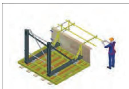
**Figura 3.5.3.33. Montaje de plataformas de trabajo en coronación, vinculadas a la estructura soporte**
