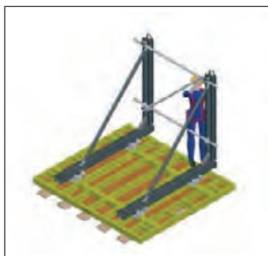
**Figura 3.5.3.32. Montaje de estructura soporte del encofrado (sobre cara no encofrante)**
