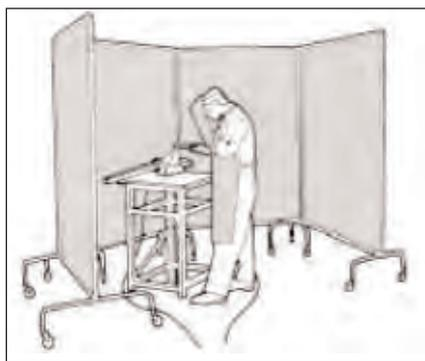
**Figura 3.6.17 Pantalla protectora en el puesto de soldadura**
