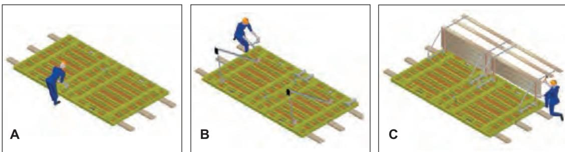
**Figura 3.5.3.15. Encofrado modular. Fases de montaje A, B y C**
