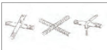
**Figura 3.6.11. Atado de barras de ferralla con alambre**
