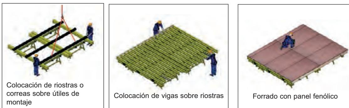
**Figura 3.5.3.18-A. Encofrado estandarizado a medida. Fase de montaje A**
