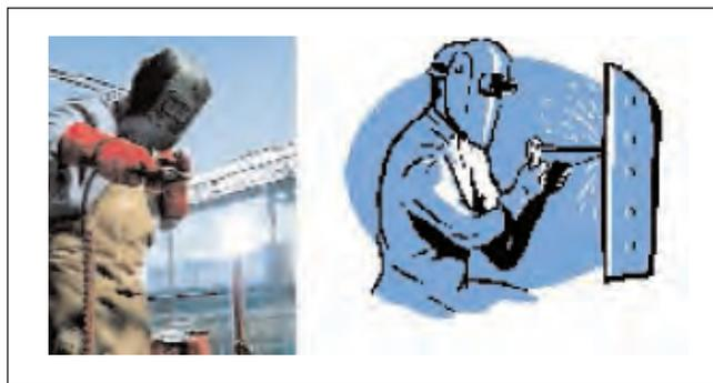
Figura 3.6.16 Careta de protección para realizar soldaduras
