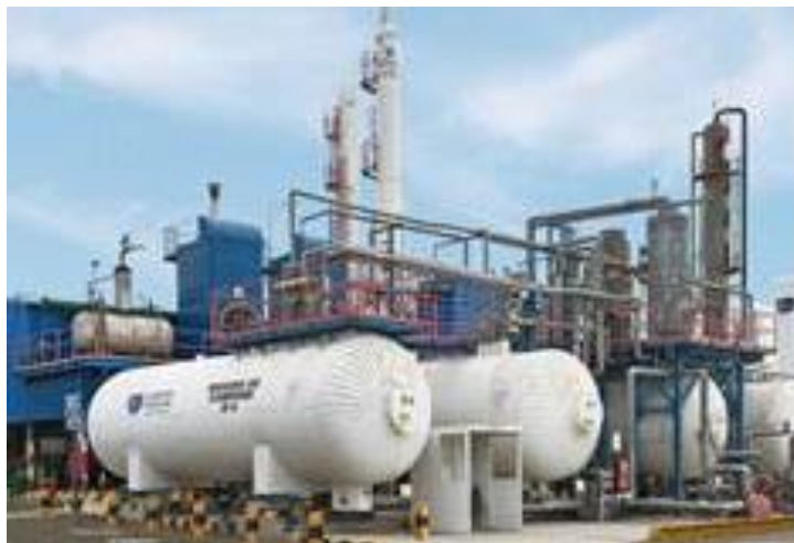
Ilustración 1: Recuperación de CO 2 procedente de la producción de vidrio en Canarias en post-combustión (fuente: Carbuos Metálicos)
