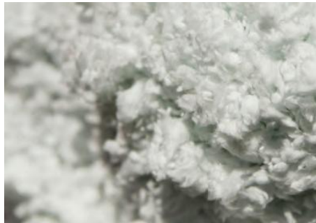
Imagen 5. Lana Mineral virgen, sin ligante, para insuflado de cámaras de aire
